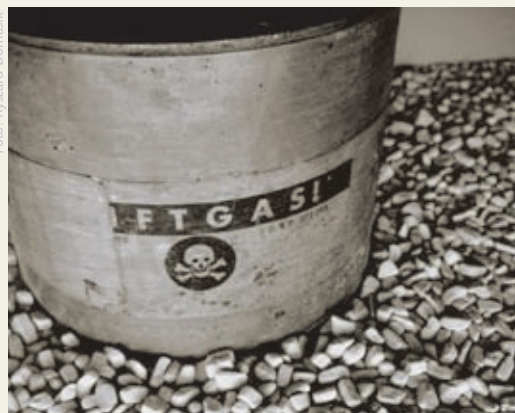
Plechovka po spotřebovaném cyklonu B a granulovaná křemelina nasycená kyanovodíkem, ze které se po otevření obalu uvolňoval plyn.
